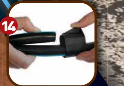
Pour fermer les extrémités du tuyau principal, installez l'anneau de fermeture en pliant le tuyau
