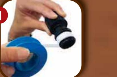
Enroulez le filetage mâle des raccords avec du ruban joint d'étanchéité
