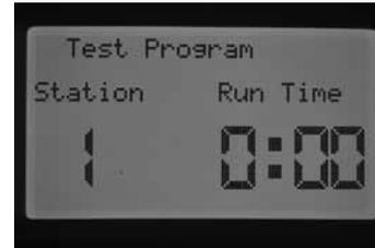
3. Utilisez le bouton + pour augmenter le temps de fonctionnement clignotant de 1 à 15 minutes. Chaque station fonctionnera pendant ce temps sélectionné.
