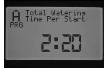
1. Placez le sélecteur sur la position FONCTION AVANCÉES. Utilisez ▲ et ▼ pour sélectionner TOTAL WATERING TIME (TEMPS D'ARROSAGE TOTAL) et utilisez le bouton + pour valider.
