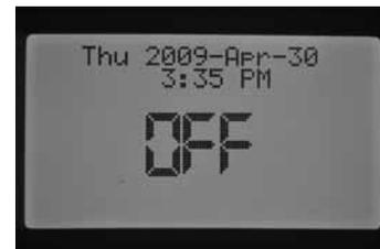
Il est également possible de définir une période programmable pendant laquelle le programmeur restera éteint dans la position du sélecteur Arrêt du système. Il s'agit de la fonction Programmable Rain Off (Arrêt d'arrosage programmable), qui sera abordée dans la section correspondante.
