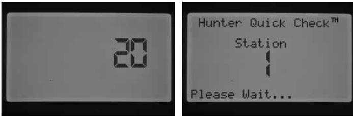
Le programmeur effectue une recherche sur toutes les stations pour détecter un chemin à courant élevé entre les bornes de station. Lorsqu'un court-circuit est détecté dans une station, un message d'erreur s'affiche à l'écran du programmeur pour chaque station défectueuse.
