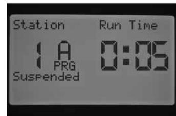
Une commande à distance d'une station unique désactive l'état de la sonde (que la station soit réglée pour répondre ou non) et cette station effectue l'arrosage pendant le temps de fonctionnement désiré. Lorsque
