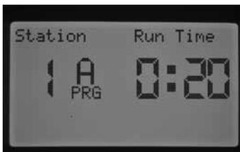
Le temps de fonctionnement des stations clignote. Utilisez le bouton ◀ ou ► pour sélectionner la station du programme par laquelle commencer et le bouton + / - pour sélectionner un autre temps de fonctionnement pour le numéro de station spécifique affiché à l'écran. Toute station suivant la première station activée fonctionnera pendant son temps de fonctionnement programmé automatique.
