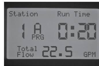
Le programmeur arrête la station et la met en pause pendant environ une minute pour permettre la stabilisation du débit irrégulier.
